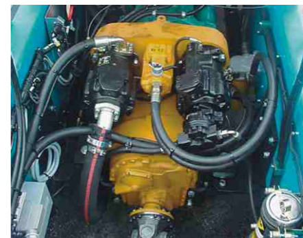
叉车配置的载荷液压感应系统根据货物重量调整提升动力，只有在需要时提供最大动力。换言之，低耗油的同时，降低排放及噪音。
